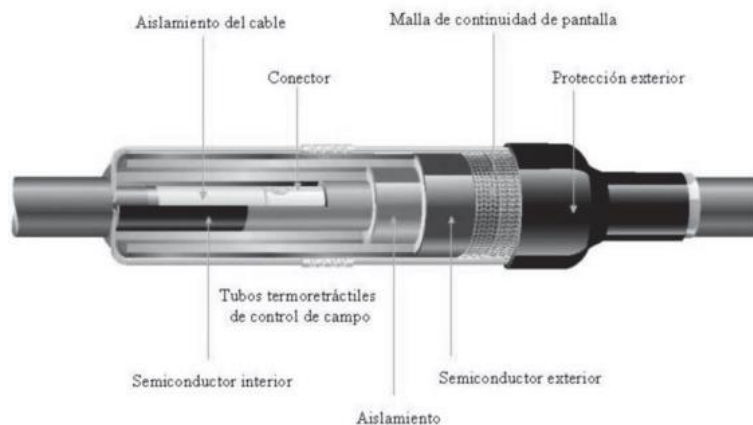
Ilustración. Empalmes termo-retráctiles
